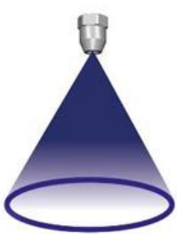
پاشش چتری Hollow Cone
